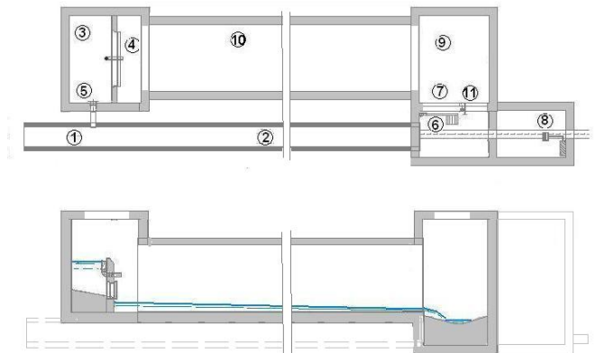
Principopbygning af rektangulært bassin med skyllesystem
